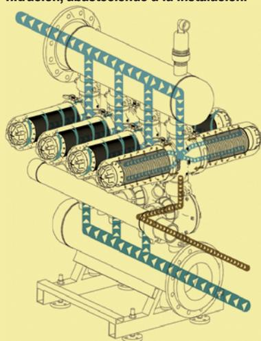
**FASE DE FILTRADO:** El agua al entrar en el filtro se encuentra con la Hélice originando un movimiento helicoidal centrífugo que aleja las partículas de los discos.
