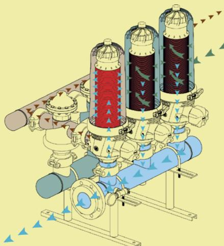
**ETAPE DE FILTRATION:** L'eau entrant dans le filtre se traverse avec l'hélice provoquant un mouvement hélicoïdal centrifuge, qui éloigne les particules des disques.
